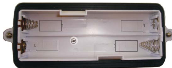
Zasobnik na baterie z zaznaczoną polaryzacją.
